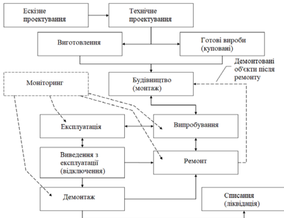
Рис. 4. Укрупнений життєвий цикл елемента (підсистеми) системи централізованого теплопостачання
